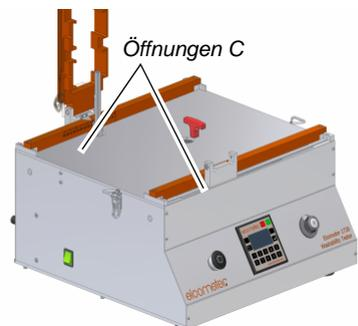
**Abbildung 14. Fetten Sie die Mechanik durch die Öffnungen C**
