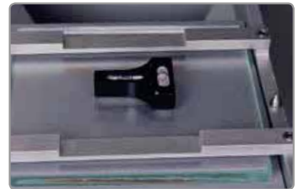
2軸式水準器で試験機を水平に設置
